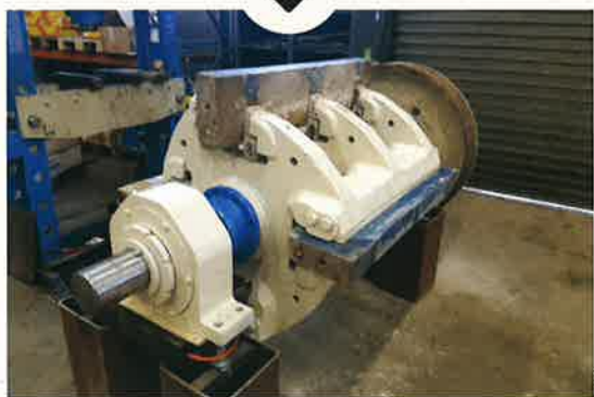
Rénovation du rotor d'un concasseur à percussion avec son rééquilibrage.
